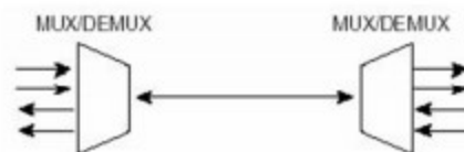
Slika 16. Dvosmjerni DWDM sustav
