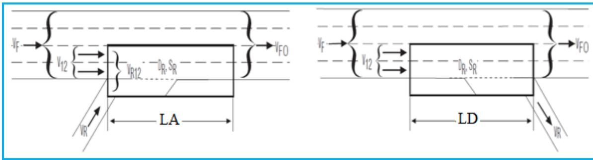
Slika 39. Osnovne varijable za zone ulijevanja i izlijevanja [24]
