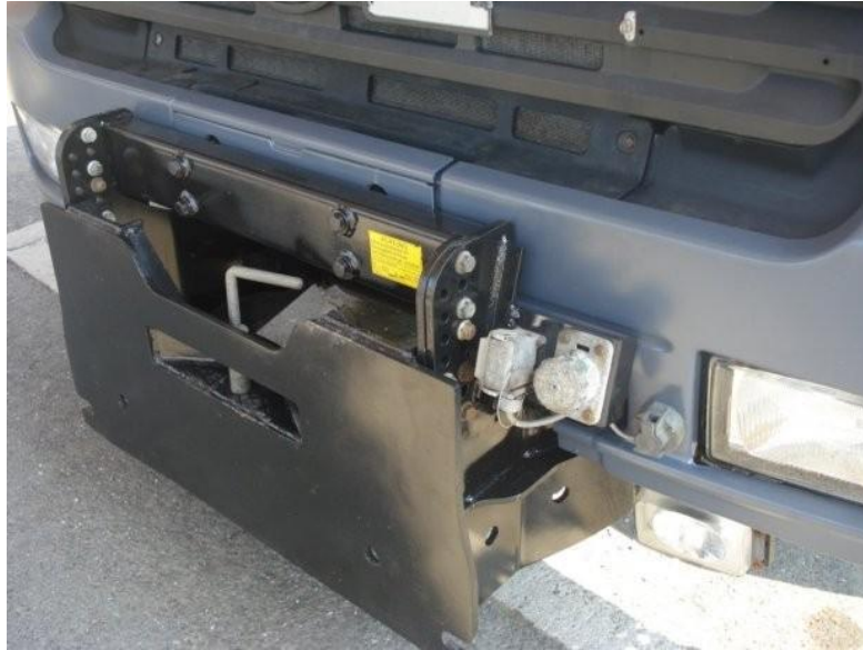
Slika 5. Prednja ploča (prihvat snježnog pluga) 10
