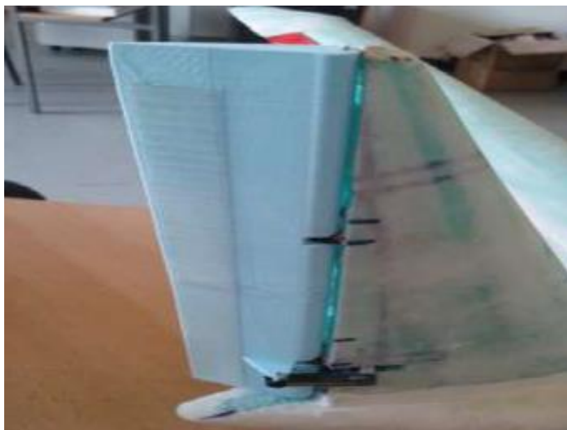
Slika 5. Kormilo pravca na vertikalnom stabilizatoru
