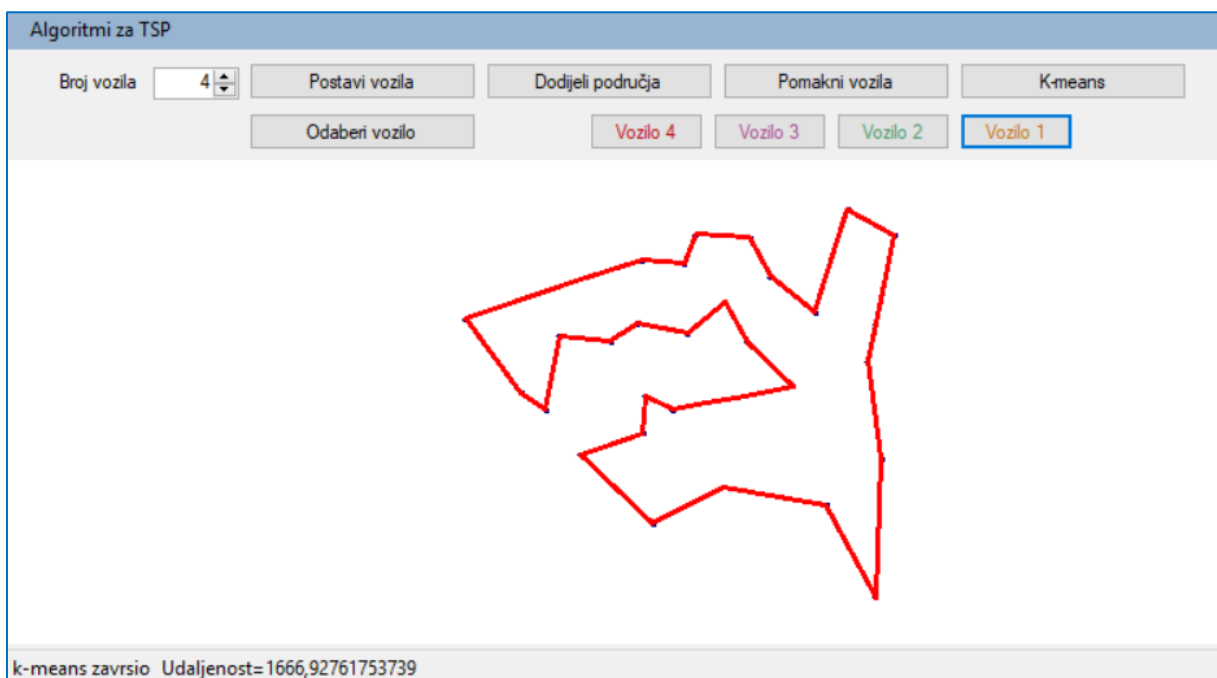
Slika 19: Izvršavanje 2-Opt algoritma za vozilo 1, [Izradio autor]
