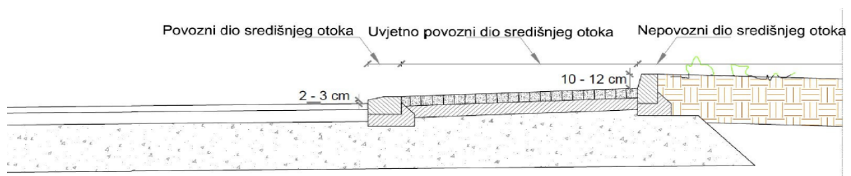
Slika 3.18. Dijelovi središnjeg otoka turbo kružnog raskrižja [7]
