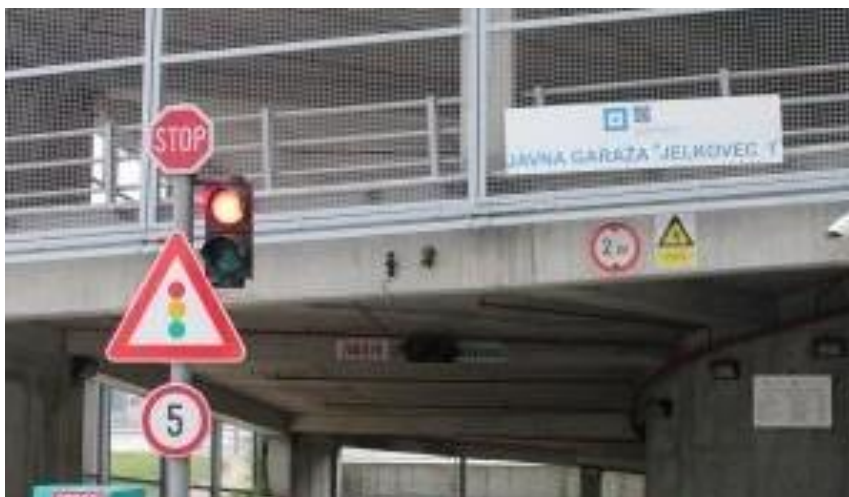
Slika 18. Prikaz svjetlosne signalizacije koje omogućuje sigurno kretanje vozila kroz etaže garaže
