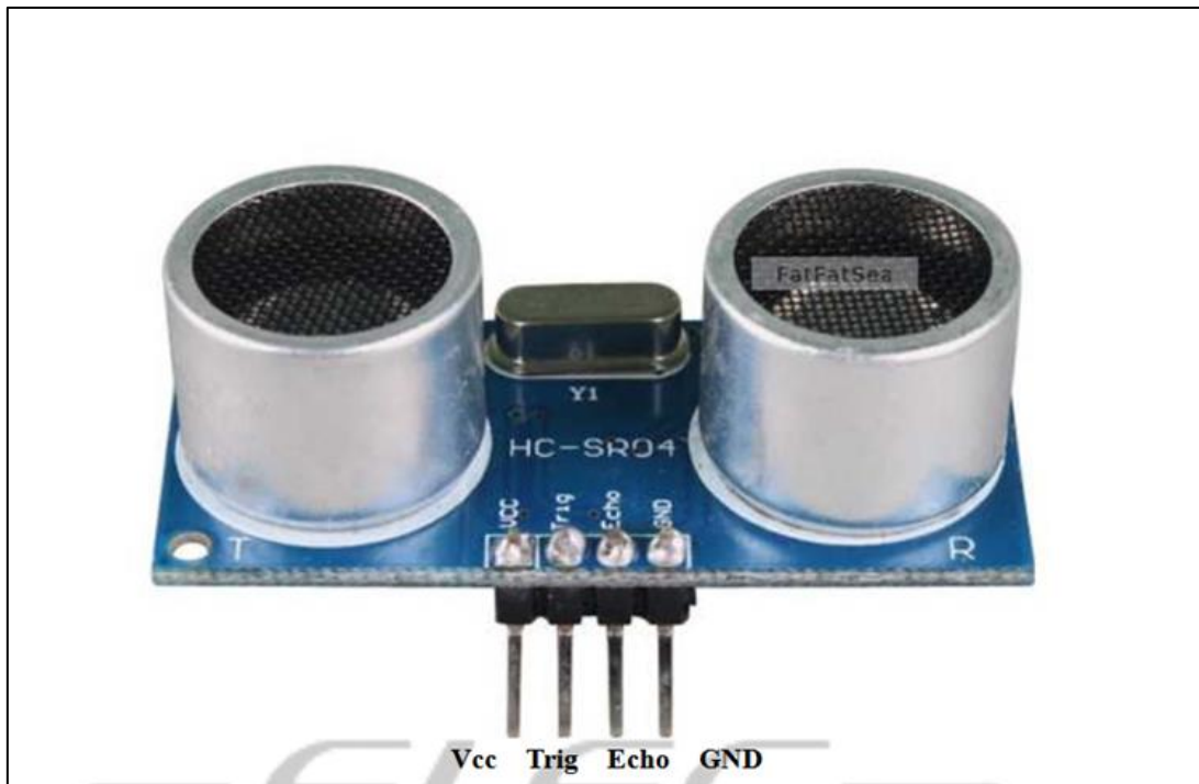
Slika 8. Ultrazvučni senzor HC-SR04 [16]
