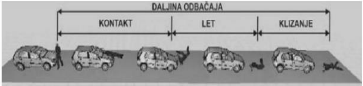
Slika 7. Faze frontalnog naleta
