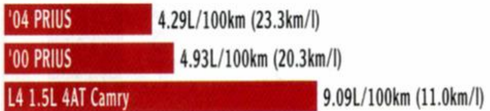
Grafikon 8 Potrošnja goriva (l/100km) triju generacija hibrida Prius i sličnog konvencionalnog automobila. [20]
