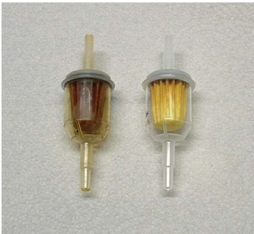
Slika 7. Zagađeni pročistač goriva (lijevo) i novi pročistač goriva (desno) [10]
