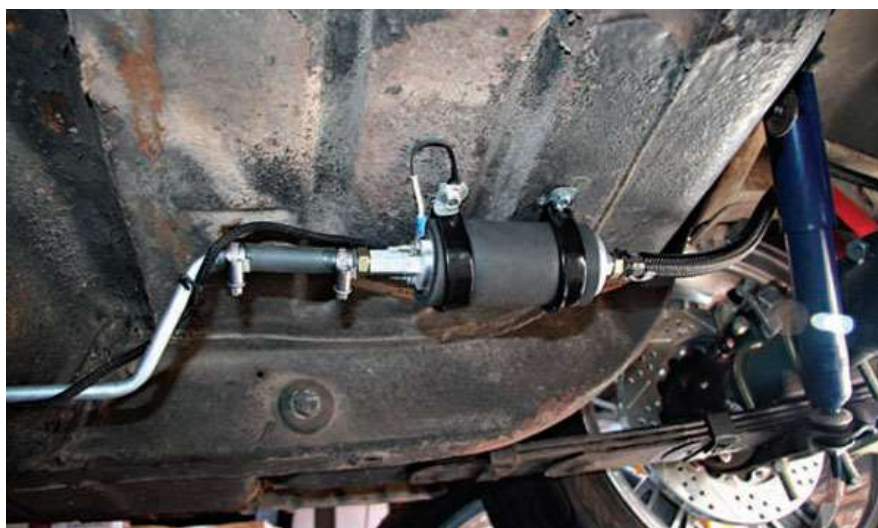
Slika 6. Električna pumpa za gorivo izvan spremnika [9]
