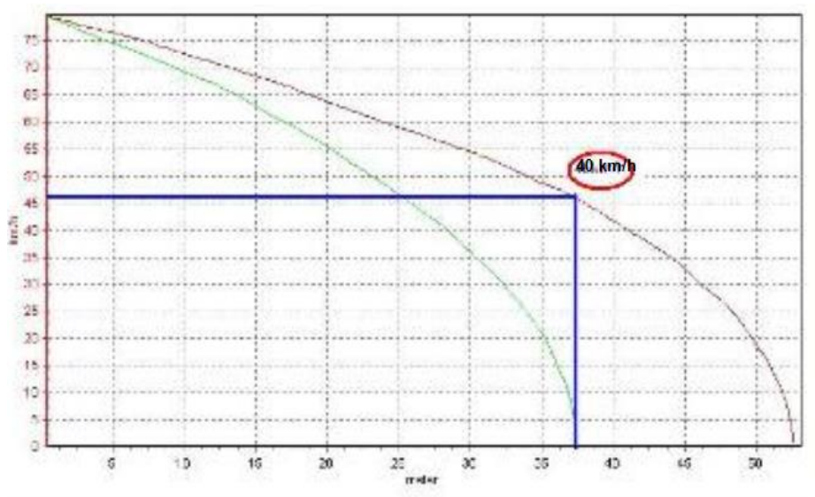
Slika 13. Duljina zaustavnog puta u ovisnosti o brzini, [23]
