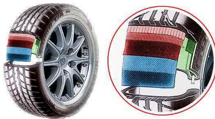
Slika 4. Sastavni dijelovi radijalnog pneumatika, [7]
