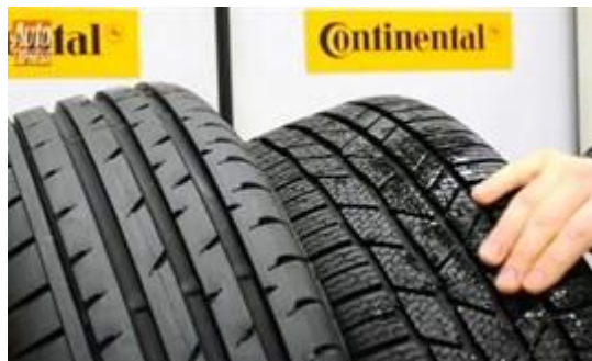
Slika 7. Izgled utora ljetnog i zimskog pneumatika, [20]
