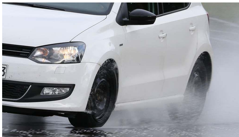
Slika 14. Primjer testiranja aquaplaninga, [24]
