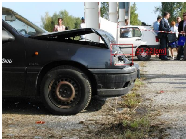
Slika 5.28. Dubina oštećenja vozila Opel Vectra
