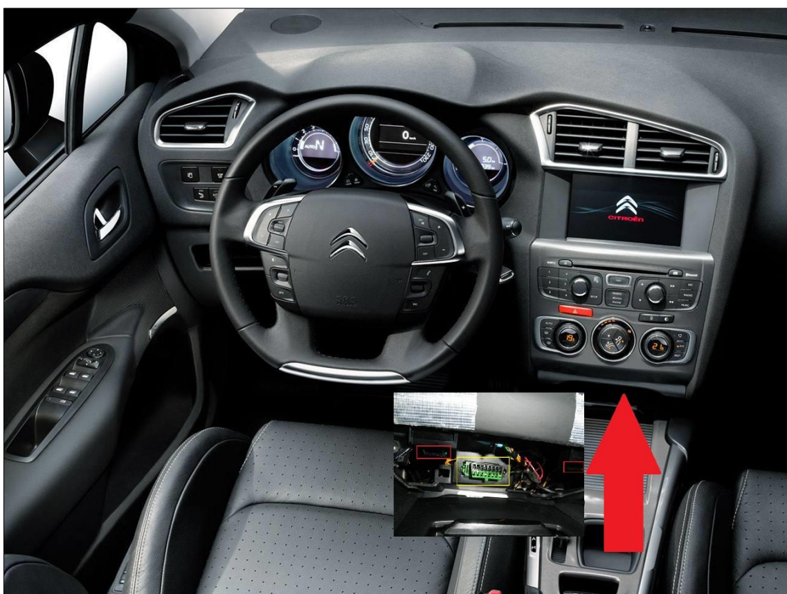
Slika 16. Pozicija OBD-2 konektora u Citroenu C4
