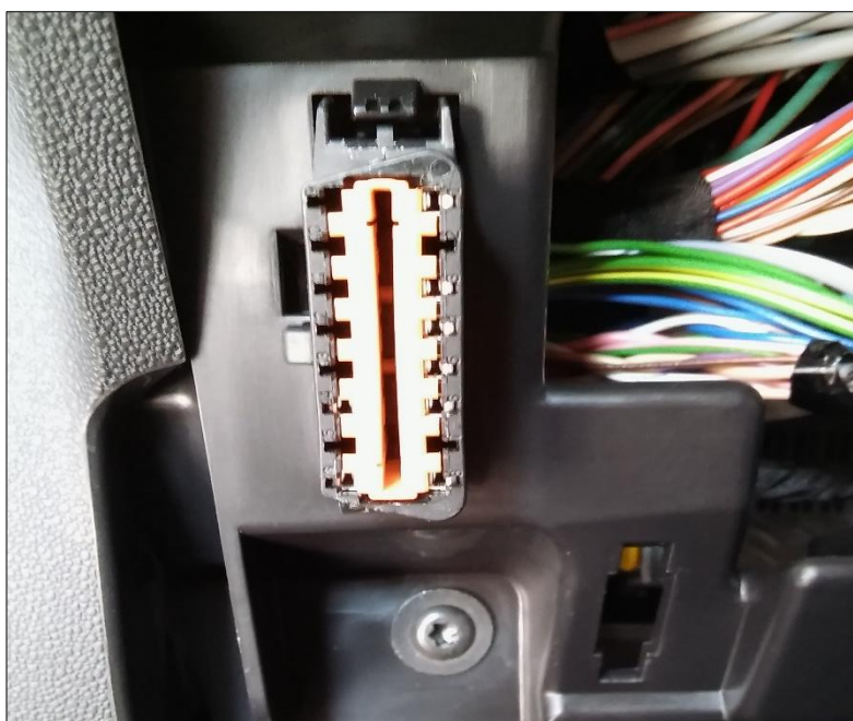
Slika 27. Lokacija DLC priključka
