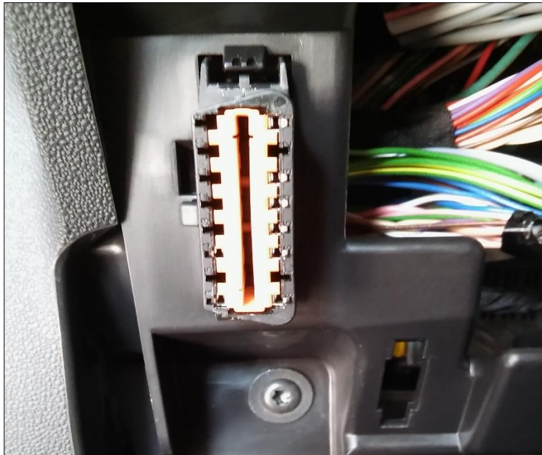
Slika 27. Lokacija DLC priključka
