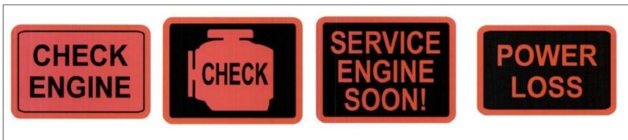
Slika 10. Izgled MIL lampica Izvor: [3]
