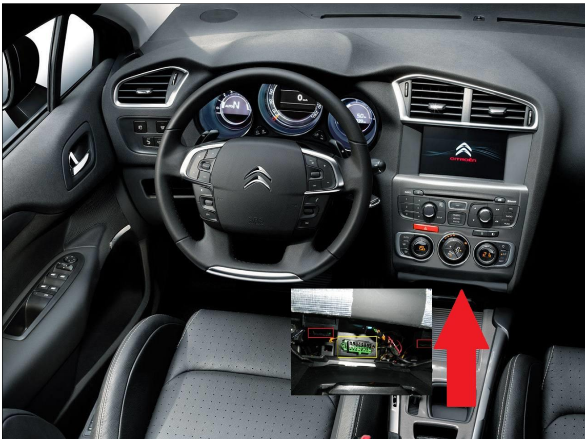
Slika 16. Pozicija OBD-2 konektora u Citroenu C4
