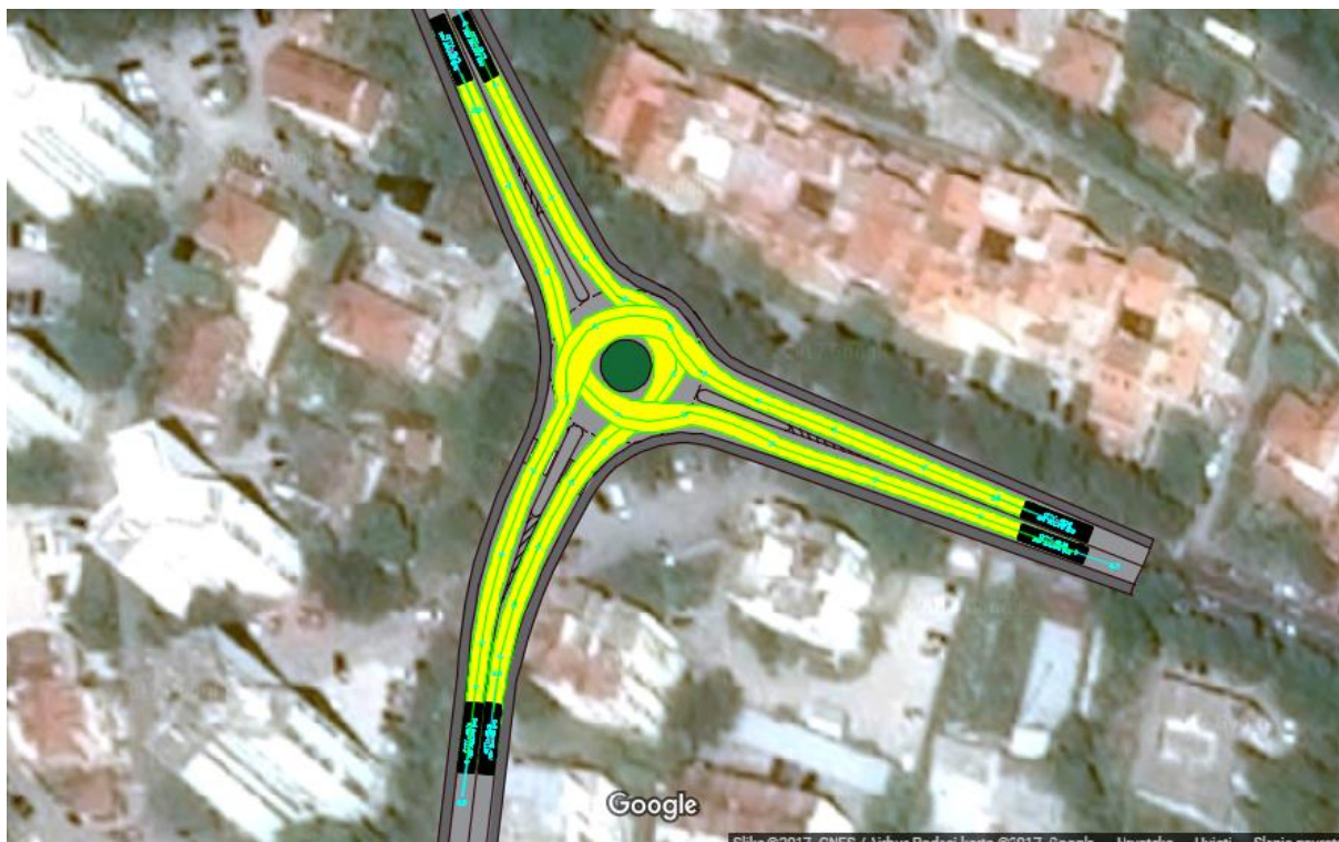
Slika 34. Trajektorije teretnog vozila izrađene programskim alatom AutoTURN
