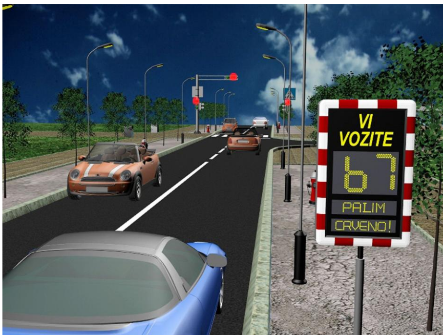
Slika 36. Brzina iznad dozvoljene detektor šalje poruku „PALIM CRVENO“
