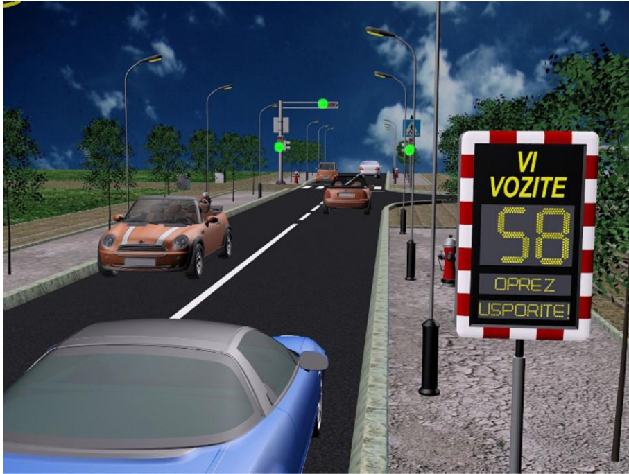
Slika 35. Detektor šalje poruku „OPREZ USPORITE“ kad je brzina prekoračena
