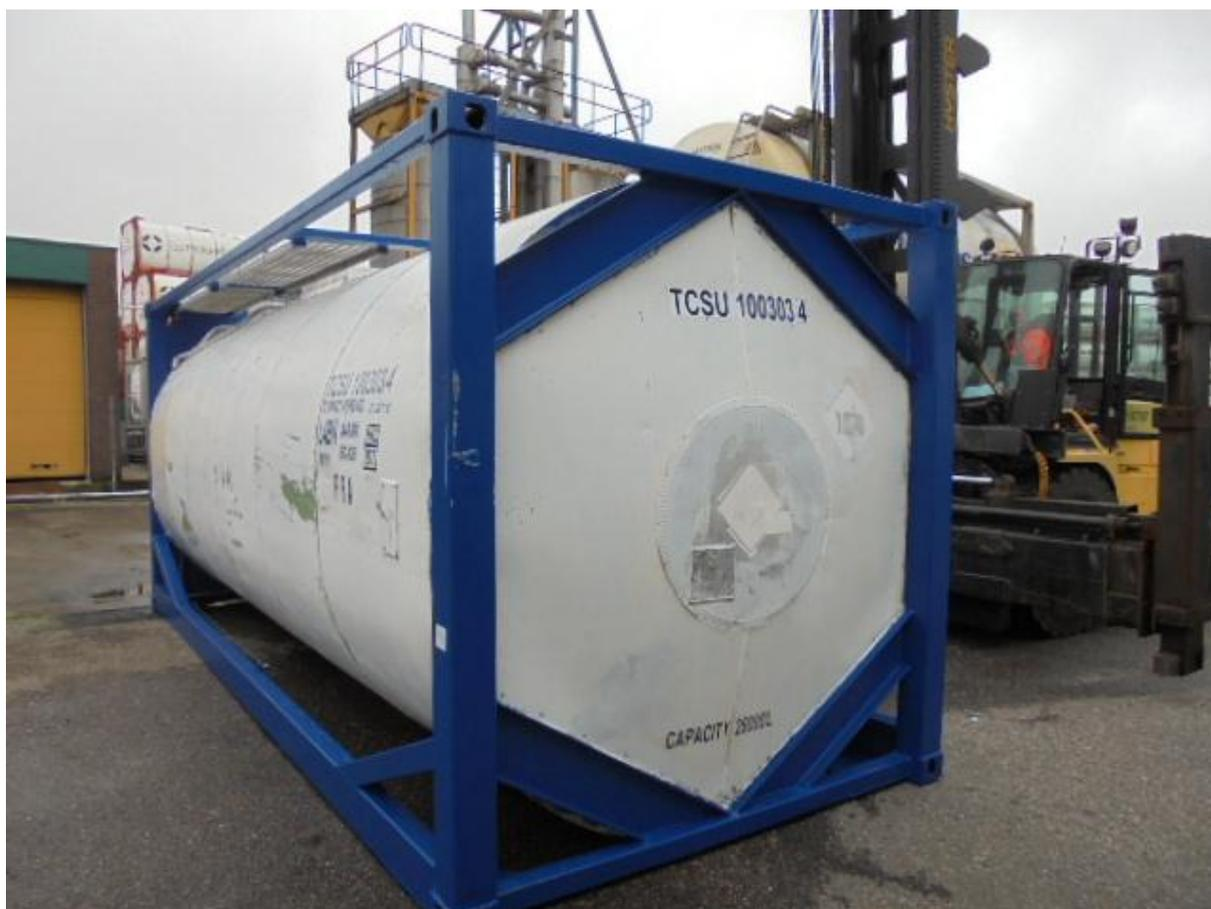
**Slika 17 20-stopni tank kontejner, IMO-1**
