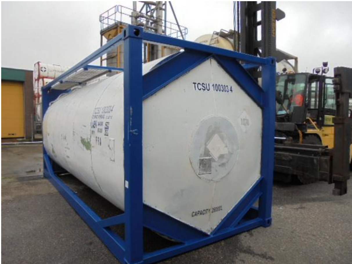
Slika 17 20-stopni tank kontejner, IMO-1
