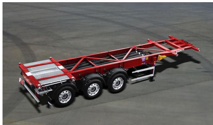
Slika 4. Rešetkasta poluprikolica za transport kontejnera
