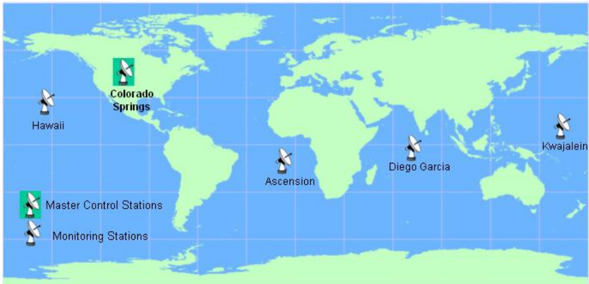
Slika 3. Kontrolne stanice za praćenje GPS satelita, [3]
