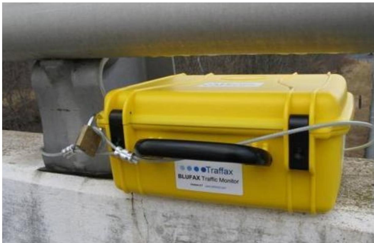
Slika 8. Blufax senzor u zaštitnoj kutiji [20]
