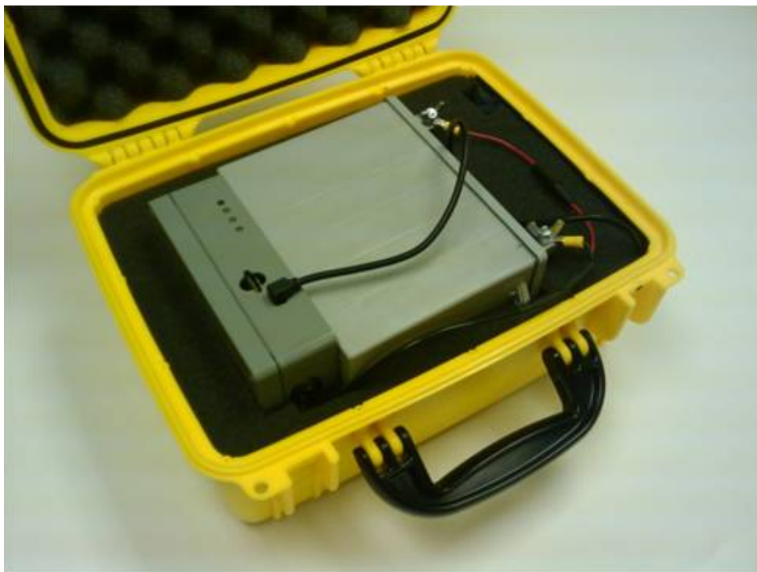
Slika 9. Blufax senzor u zaštitnoj kutiji [20]
