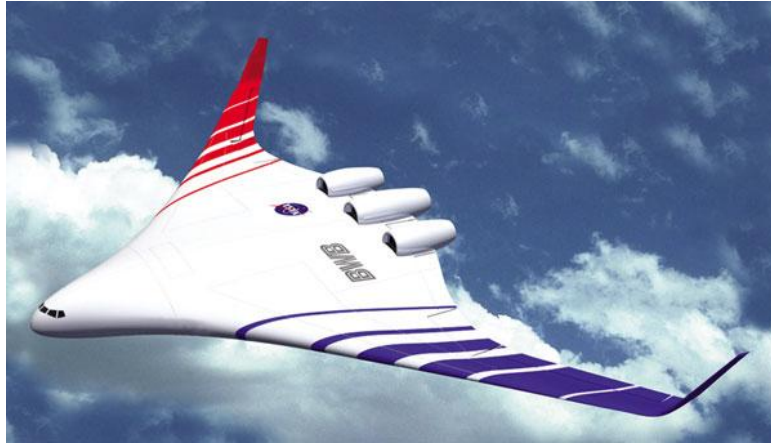
Slika 8. BWB zrakoplov nove generacije, [12]
