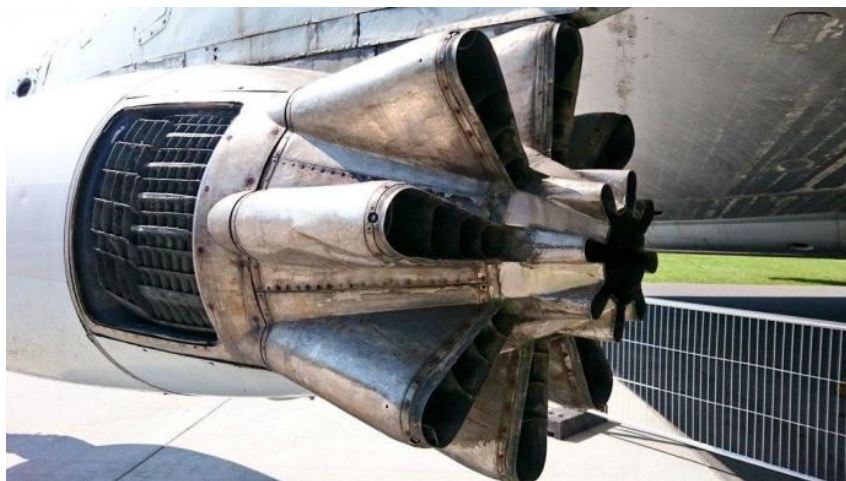
Slika 12. Utišivač buke motora, [17]
