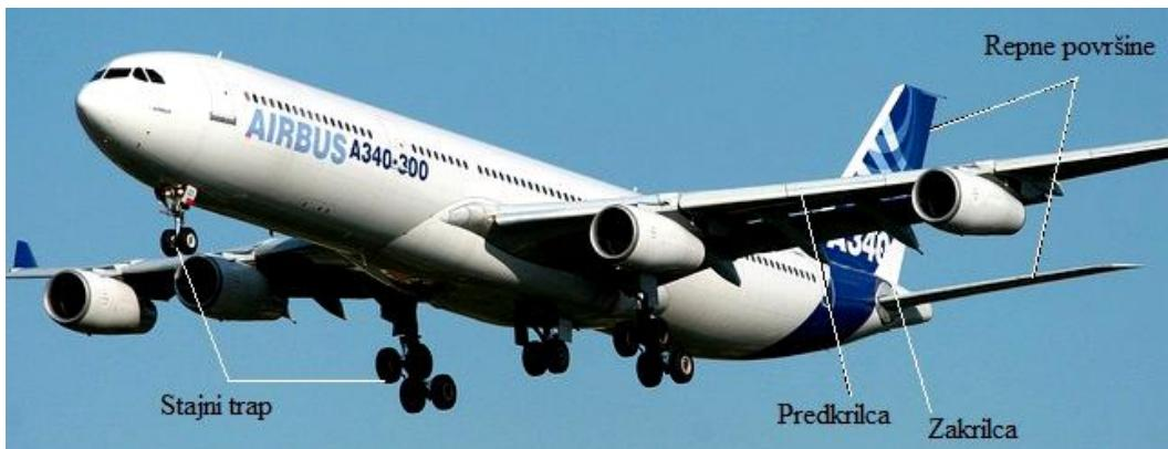
**Slika 5.** Izvor buke strukture zrakoplova, [7]
