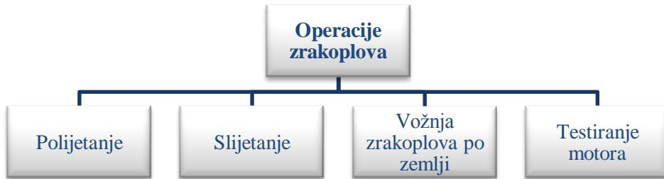
Slika 2. Izvor buke ovisno o operaciji zrakoplova,
