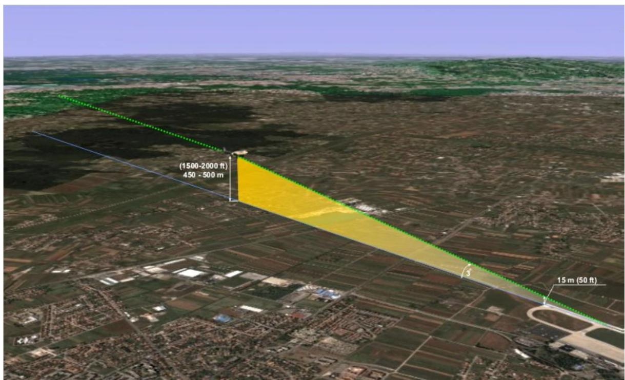
**Slika 18.** Standardni postupak slijetanja na MZLZ, [6]
