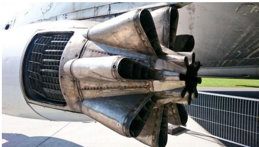
Slika 12. Utišivač buke motora, [17]
