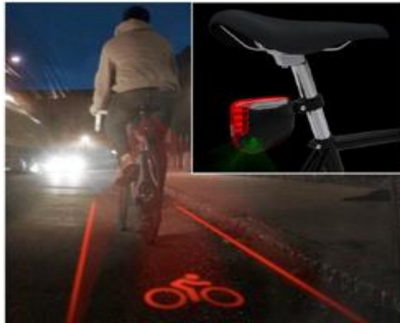
Slika 54. Prikaz kreiranja virtualne biciklističke trake Izvor: [4]
