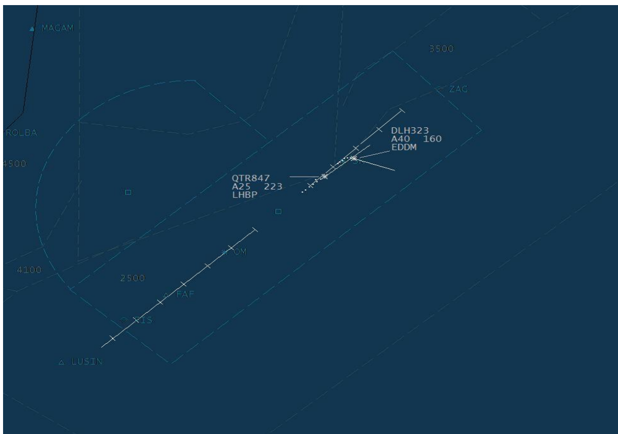
Slika 10- Primjer prometne situacije zrakoplova koji slijedi proceduru neuspjelog prilaženja i zrakoplova u odlasku
