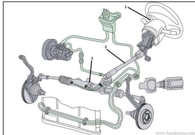
Slika 3. Upravljački mehanizam
