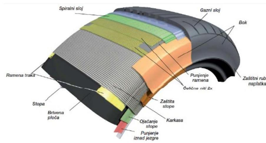
Slika 4. Presjek pneumatika
