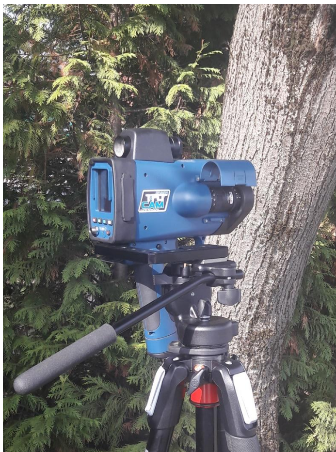
Slika 19: TruCAM Laser Speed Gun kojim su obavljena mjerenja brzina
