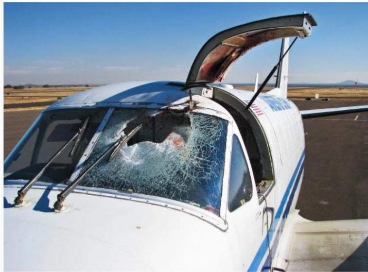
Slika 12. Oštećenje vjetrobranskog stakla zrakoplova
