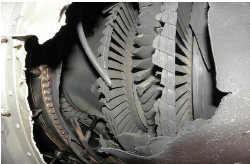
Slika 14. Oštećenje lopatica kompresora motora
