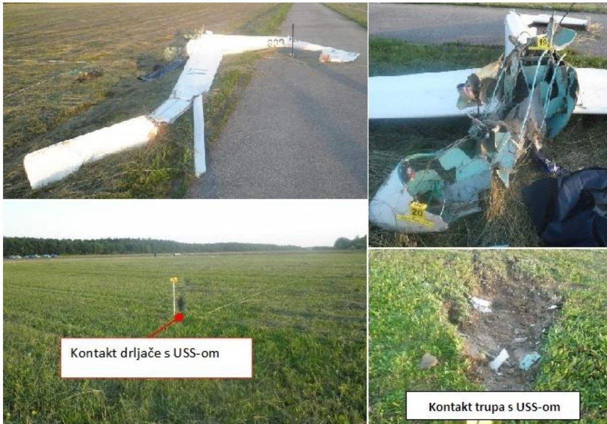
Slika 10. Oštećenja na jedrilici i USS-i [43]
