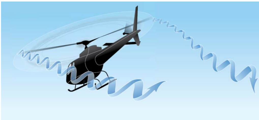
Slika 12. Spiralni vrtložni tragovi helikoptera u letu prema naprijed, [2]
