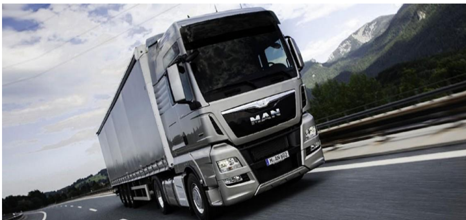
Slika 5. Tegljač s poluprikolicom nosivosti do 25 tona
