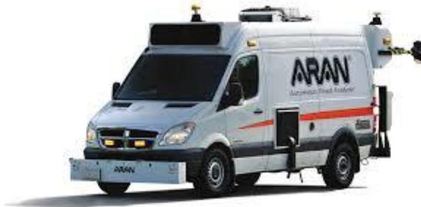
Slika 7. Suvremeno ARAN vozilo za mjerenje kolnika
