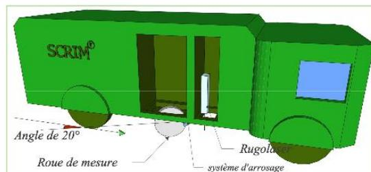
Slika 8. Simulacija SCRIM vozila za mjerenje otpora klizanja
