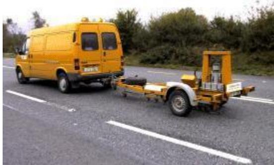
Slika 9. FWD vozilo za mjerenje stanja kolnika
