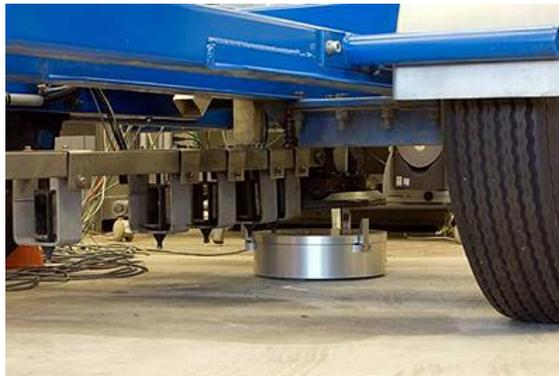
Slika 10. Suvremeno FWD vozilo za mjerenje stanja kolnika
