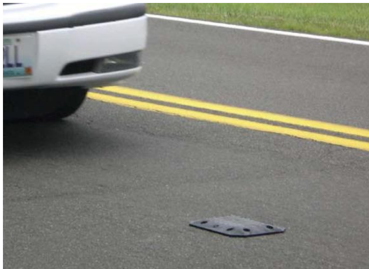
Slika 6. Prenosivo automatsko brojilo prometa Nu-Metrics NC-200 tvrtke Vaisala, [5]
