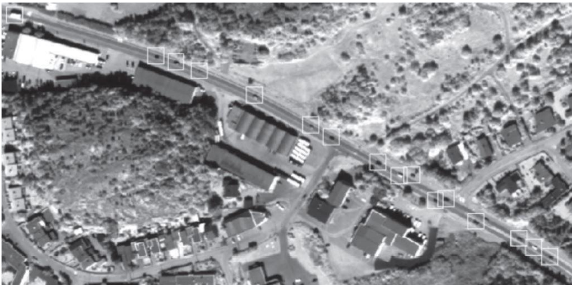
Slika 11. Detekcija vozila putem satelitskih snimaka visoke rezolucije, [11]
