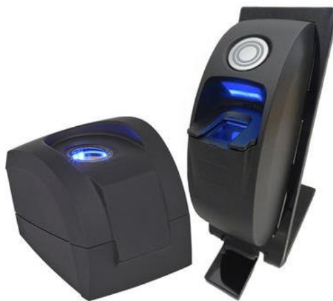
Slika 3. Biometrijska identifikacija na osnovi otiska prsta
