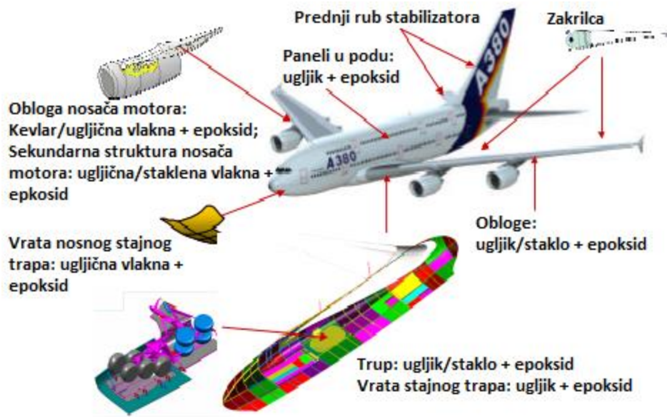
Slika 17. Dijelovi A380 od sendvič konstrukcija Izvor: Jerome Pora: Composite materials of Airbus A380 -From History to Future-, Airbus, Large Aircraft Division
