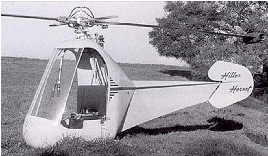
Slika 6. Hiller HJ-1 Hornet tip-jet helikopter.
