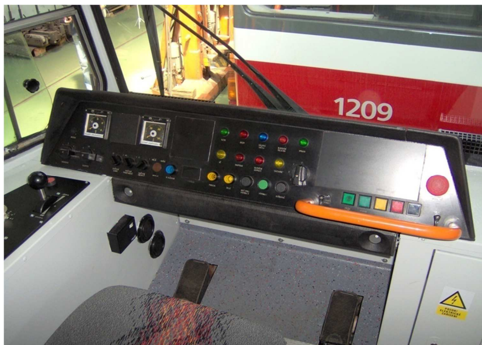
Slika 12. Vozačka kabina u tramvaju T6A5
