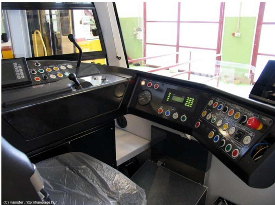
Slika 45. Vozačka kabina u tramvaju Cambino supra
