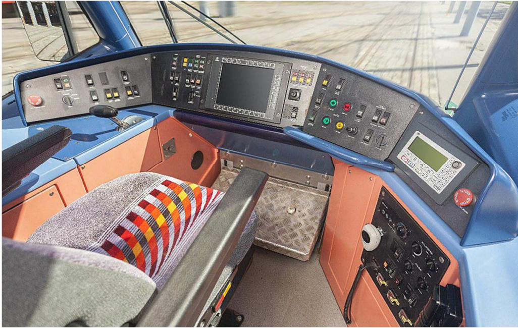
Slika 17. Vozačka kabina u tramvaju Škoda 14T
