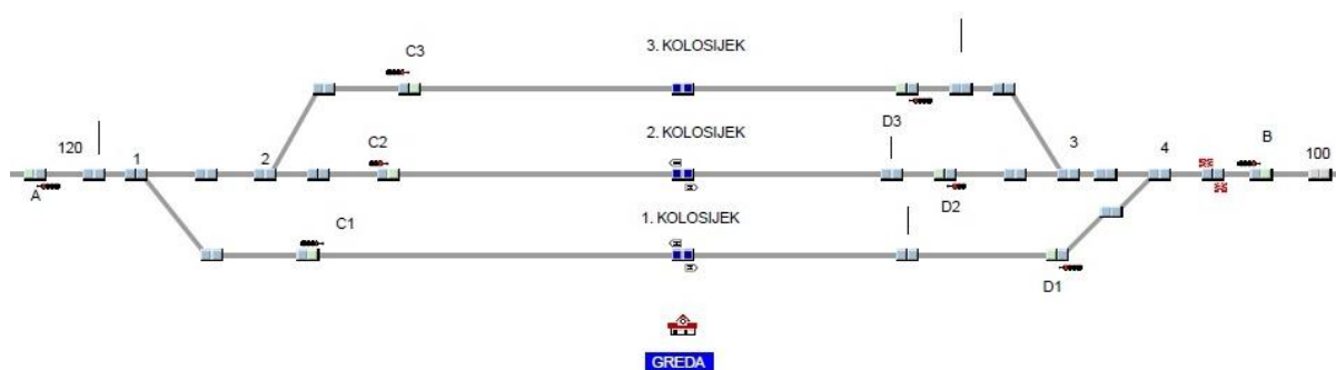
Slika 6. Kolosiječna shema kolodvora Greda
