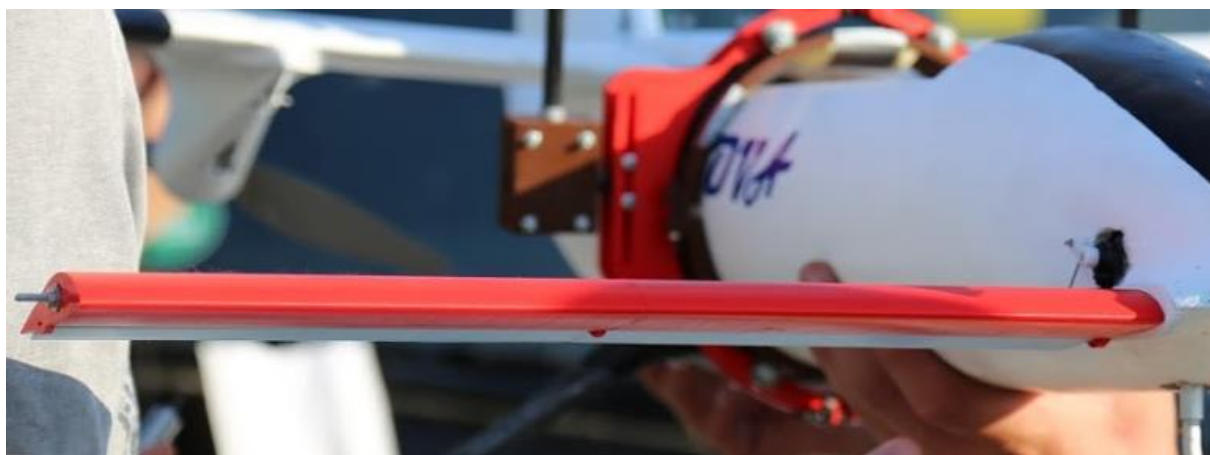
Slika 27 - Ugrađeni kanard (crveno) + kormilo dubine (plavo)
