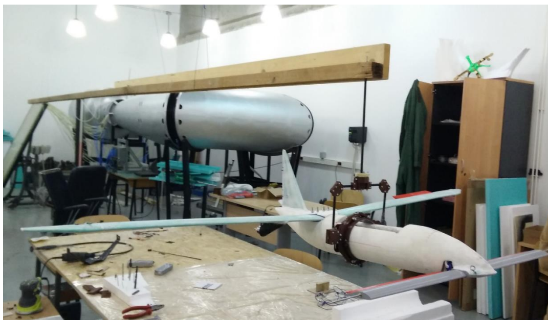
Slika 15 - Letjelica SOVA ovješena na kardanskom ovjesu
