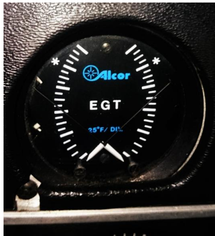
Slika 15: Instrument za mjerenje temperature ispušnih plinova – EGT,[4]
