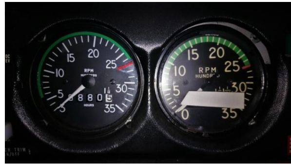
Slika 14:Instrument za mjerenje broja okretaja – RPM,[4]
