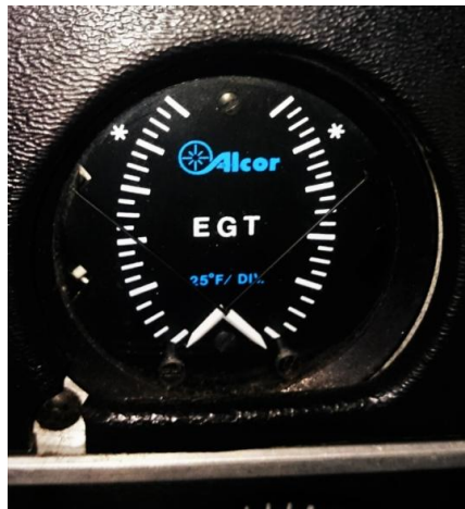
Slika 15:Instrument za mjerenje temperature ispušnih plinova – EGT,[4]
