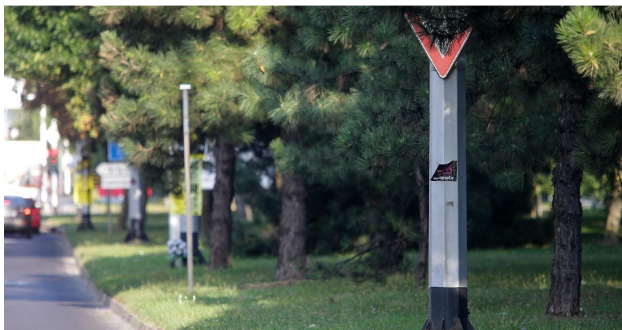
Slika 32. Nepreglednost prometnog znaka [26]
