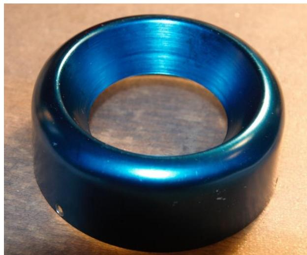
Slika 7. Uvodnik turbomlaznog motora JJ-1400.
