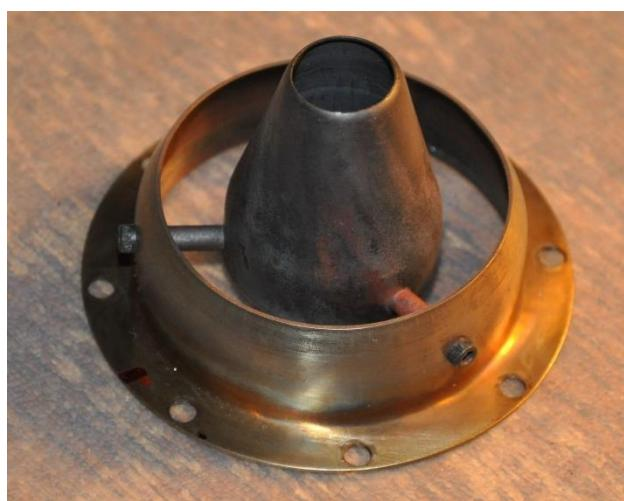
Slika 10. Mlaznica turbomlaznog motora JJ-1400.
