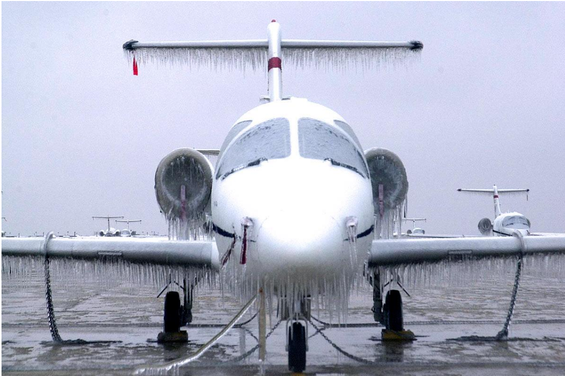
Slika 1. Potpuna kontaminacija površine zrakoplova ledom
