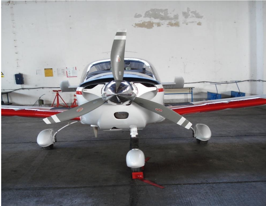
Slika 4. Usisni otvori na prednjem dijelu nosa zrakoplova 10
