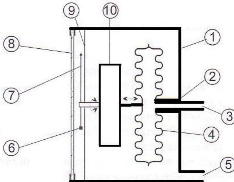
Slika 4.5.1.1. Shematizirani mehanizam mehaničkog brzinomjera [1]
