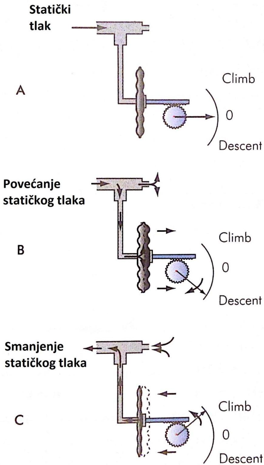
Slika 4.5.2.3. Načelo rada variometra: a) let na stalnoj visini; b) spuštanje; c) penjanje [2]
