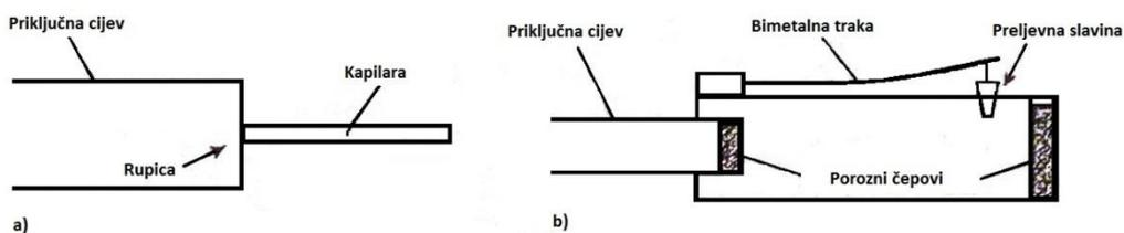
Slika 4.5.2.2. Restriktor: a) s rupicom i kapilalom, b) s poroznim čepovima i prejevnom slavinom [1]
