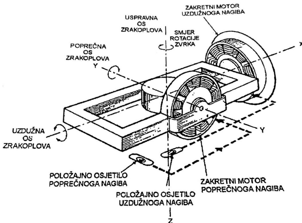
Slika 5.6.2.1. Sustav automatskog uspravljanja zvrka sa zakretnim motorima [1]
