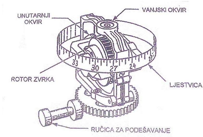
Slika 5.5.1. Shematski prikaz mehanizma prikaznika kursa starije konstrukcije [1]
