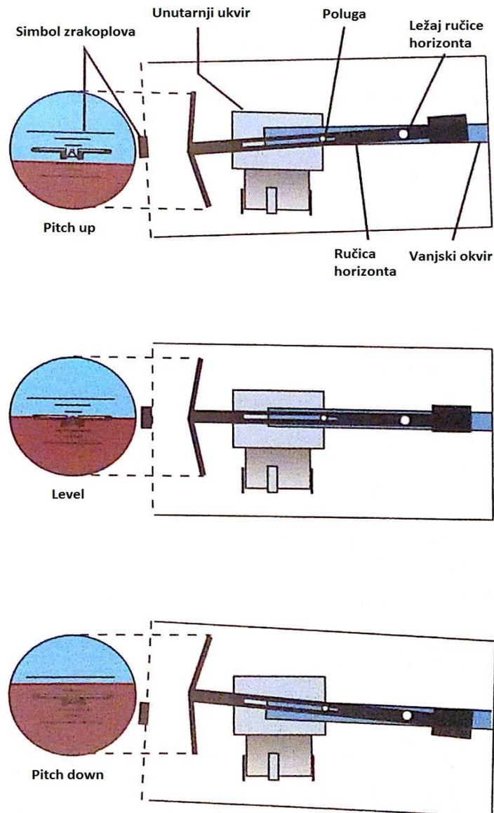
Slika 5.6.1.3. Princip rada umjetnog horizonta [2]
