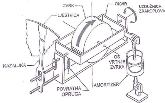
Slika 5.4.1.1. Shematski prikaz mehanizma prikaznika skretanja [1]
