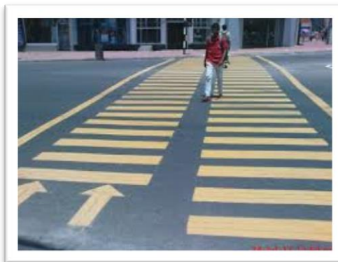
Slika 4: Pješački prijelaz s odvojenim tokovima [13]
