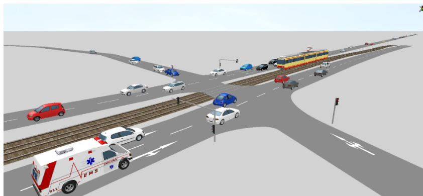
Slika 9: Prikaz izvođenja simulacije raskrižja u VISSIM-u [3]
