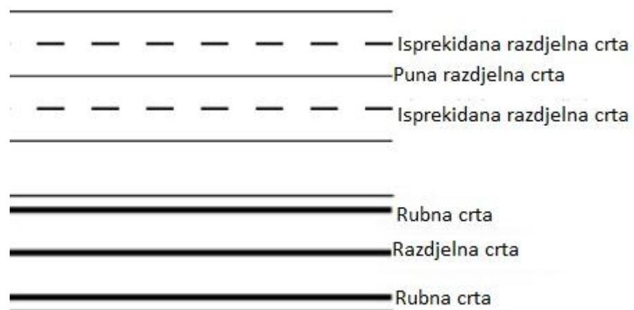
Slika 8. Primjer uzdužne horizontalne signalizacije
