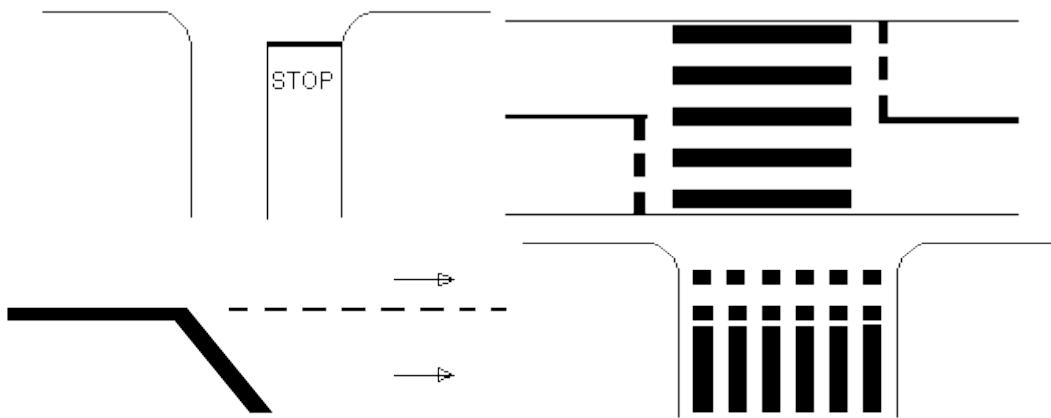
Slika 9. Označavanje poprečne i kose signalizacije na kolniku
